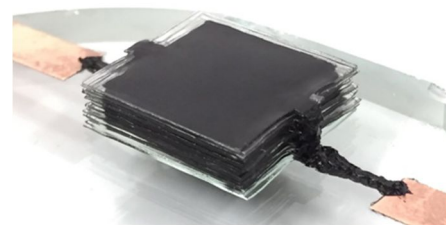
図 3 柔軟電極を用いた PVC ゲルアクチュエータ (20 層)
