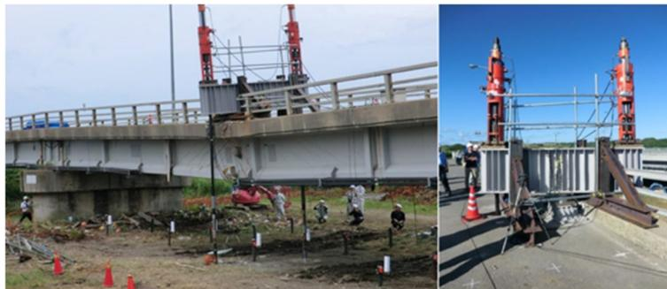
図 4-2-1 対象 PC 橋と破壊実験光景
