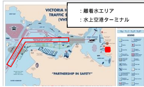
図-2 ビクトリア湾のトラフィックスキーム 出典：TransportCanada 資料に加筆
