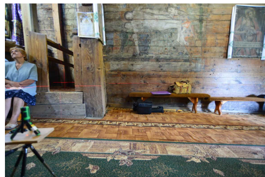
図 12. レーザー墨出機による測定
