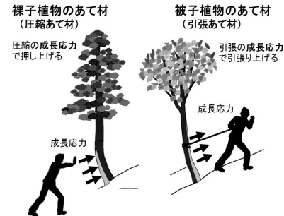
図1. あて材形成による負重力屈性の発現パターン。傾斜部分において明るく色分けしてある部分が“あて材”木部。あて材では、二次肥大成長が促進され、ここでは特異な成長応力が発生し、これが樹幹を押し上げる(圧縮あて材)か、あるいは引張り上げる(引張あて材)。
