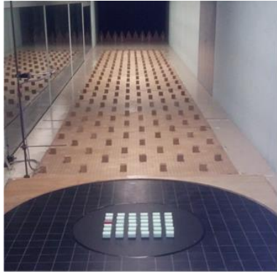
図5. 建築物群内の建築物に作用する風圧を計測する風洞実験風景
