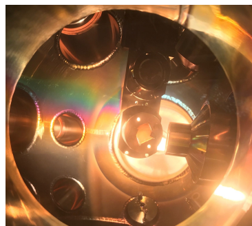
図 3 開発した赤外線加熱システムで加熱中の Si ウェハ。
