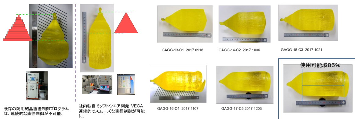
図1 GAGGの大型結晶育成に特化した直径制御用プログラムの開発(左)、開発したプログラムを用いて連続作製した結晶(右)
