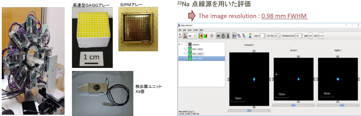
図 2 試作した高速型 GAGG アレーとそれを搭載した小型 PET 装置(左)と解像度評価試験(右)
