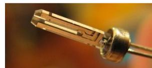
図5: ヒーター及び温度計として使う音叉型水晶振動子。
