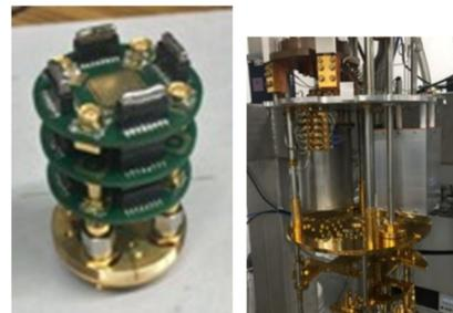
図10. 希釈冷凍機に実装したジョセフソン素子
