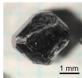
図 4 Na-Ga-Si 混合試料 (Na : Ga : Si = 4 : 1 : 2) を 773 K、21 h 加熱して得られた Na-Ga-Si クラスレート単結晶
