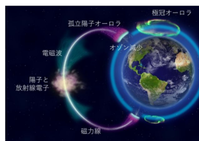
図 11. 放射線帯電子による局所的なオゾン減少の模式図 (Ozaki et al., 2022, press release 記事より)。
