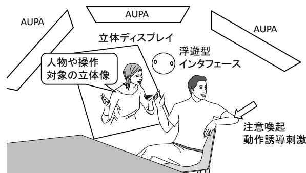
図2 空中触覚テストベンチの基本構成
