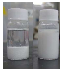
図10 BNのシクロヘキサン中分散 (左: 未修飾、右: アミン修飾)
