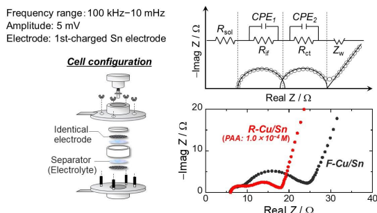
図 4 平滑および粗面化基板を集電体に用いた Sn 負極の交流インピーダンス測定結果。Na 金属の影響を無視するために、充電状態の等価な Sn 電極を 2 つ対向させ、対称セルを構築し、測定を実施した。
