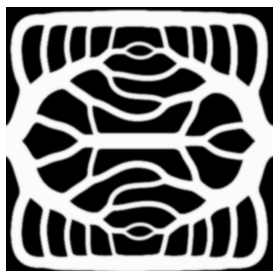
図3 最適化構造 (2次元流路構造)
