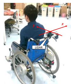
図 7 身体動作の測定 (LIDAR の設置場所)
