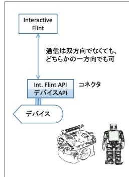
図 5: Int. Flint とデバイスが連携するためには、 デバイスがデータ通信を行うための API を有す る必要がある。
