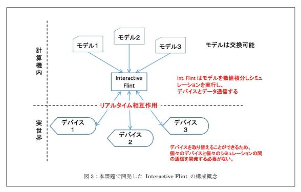
シミュレーション中のモデルの動変数などの値を出力し、その値によってデバイスを制御 (モーター駆動など)を行う。一方で、デバイスに付随するセンサーなどの値を取得し、モデル内の変数や計数に代入することで、外界の情報をシミュレーションにリアルタイムに反映させる(図4)。
