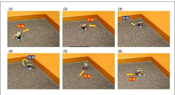
図 6: センサー付き二輪デバイスを用いた実証実験。 1 から 6 まで時間の経過順のスナップショットを示す。
