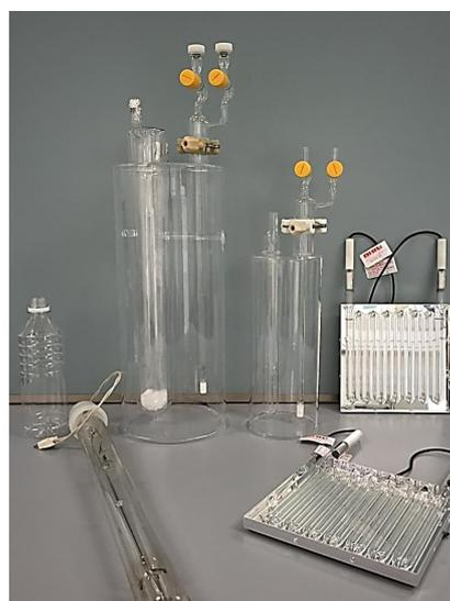
図2 UV照射装置で用いる石英反応容器とUVランプ。左側はTanaka et al. (2009) で用いた従来型。右は新たに採用した改良型。
