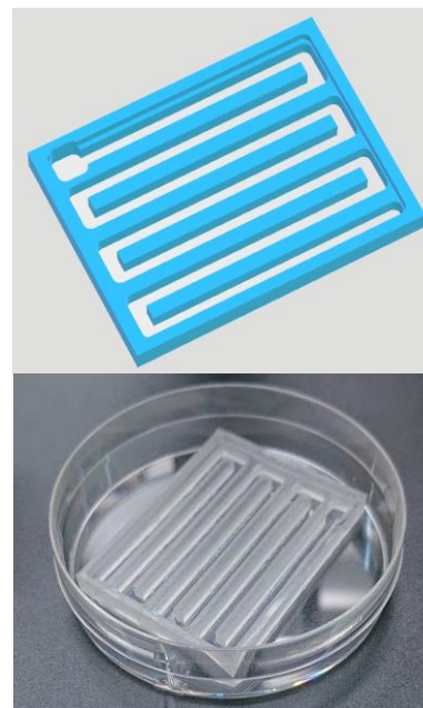
図1. 3次元CADソフトウェアを用いて設計したテーラーメイド迷路形状照射容器の壁面部品の3Dモデル(上)。デスクトップ切削加工機でポリカーボネートを切削し、カバーガラスと接着して製作したテーラーメイド迷路形状照射容器(下)。
