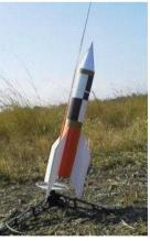
ートを上部あるいは下部に搭載できるスペースを有する。エンジンは 3 本クラスタとなっており,B 型あるいは C 型エンジンにより,それぞれ  $30 \sim 40 \text{m}$ , $60 \sim 80 \text{m}$  の飛翔が可能である。エンジンマウント部分 (図 10)はバルサ材と板バネによって構成されており,エンジンの脱着が可能となっており,ロケットの再利用を行うことが出来る。エンジンマウント部分のバルサ材は,レーザカッターにより,CAD 図面に基づいて加工されている。
