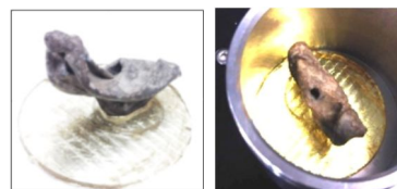
図4 出土した熔融金属片用マスク上の試料(左)と分析用試料の容器にセットした状態
