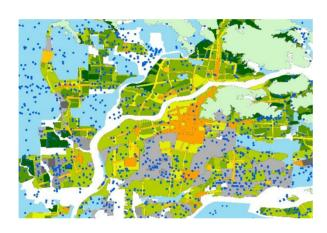
左図は岐阜市とその周辺における20KW以上のPVシステムの設置分布図である(青い点; data source:固定価格買取制度・事業計画認定情報2020、国土数値情報用途地域)。図に示されていない小容量の住宅用PVシステムと合わせて、都市とその周縁部にPVシステムが浸透し始めていることが分かる。
