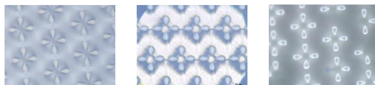
(a) Si 構造体 (b) PDMS 構造体 (c) NOA63 構造体
