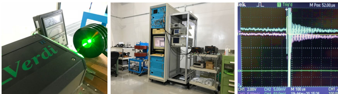
図1 室温偏極陽子固体標的@九州大学。左：レーザー、中央：全システム、右：陽子 NMR 信号
