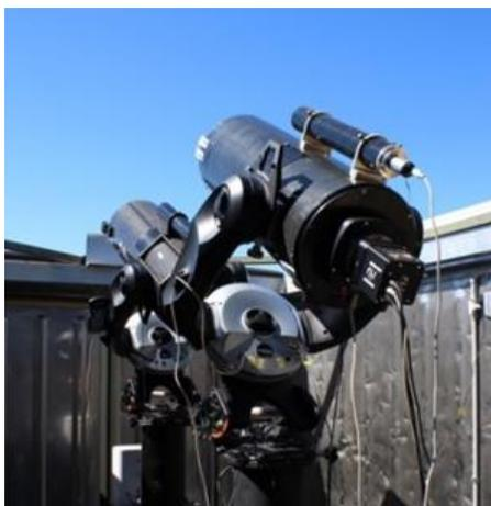
図 2 : 豪州 Siding Spring 天文台内の JAXA 遠隔観測施設。田中光化学工業製の口径 25cm 望遠鏡に FLI 製 CCD カメラを装着。現在はこの他にタカハシ製 18cm 望遠鏡 (FLI 製 CCD 装着) も稼働している。
