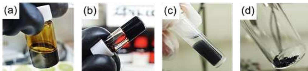
図1 (a) カルコゲナイド錯体溶液、(b) ゲル化後のカルコゲナイドゲル、(c) 収縮ゲル、(d) 凍結乾燥法で得られた非晶質カルコゲナイド微粒子
