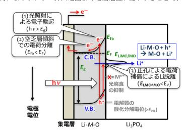
② 本研究はリチウムインサーション材料を半導体電極の観点から捉え直すものでもあり、光 非照射での通常の充放電反応制御にも有用である.実際に層状岩塩型正極材料の表面を ZrO2や Li3PO4で制御することで、液系リチウムイオン電池の課題である高電位領域におけ る電極劣化を抑制する機構を明らかにすることができた.今後、固体固体界面での電気化 学、光電気化学現象も詳細に検討していくことで、全固体電池や光蓄電デバイスの実現に 有用な構造情報を得ることが期待できる.
