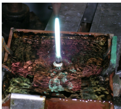
図7 燃焼炎による製作した歯科用インプラント試料へのナノ結晶ダイヤモンド皮膜合成実験画像
