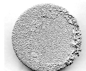
図8 樹脂サンドイッチ薄板のライニング後の試験片外観（加工時間 15s）
