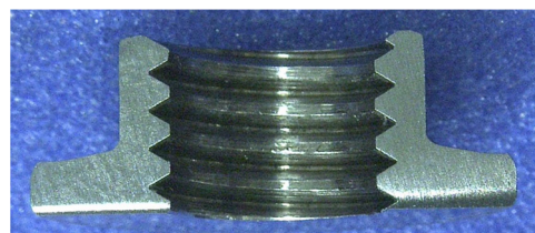
図6 試作したナットの断面形状
