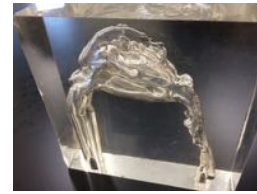
Fig. 4: ECRS 患者データを用いた可視化実験用の鼻咽頭模型
