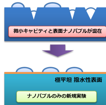
Fig.2 従来の伝熱面とナノバブル計測に用いる極平坦撥水面
