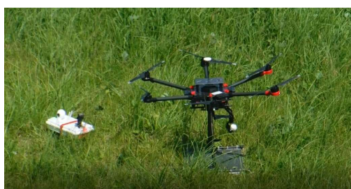
「秋吉台」小型地上走行ロボットの 空中輸送・出入庫実験
