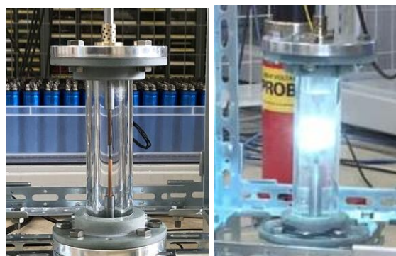
図6 試作した液中アーク限流チャンバー
