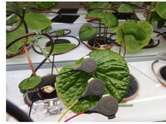
図1 葉面や茸に電極を取付け生体電位を計測中
