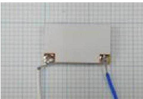
図 3 薄膜型サーマルコンバータ
