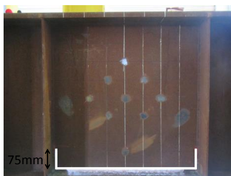
写真1 腐食模擬モデル
