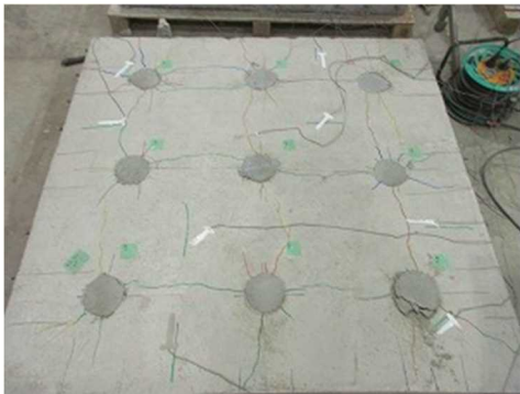
写真-3 破砕した模擬床部材の例
