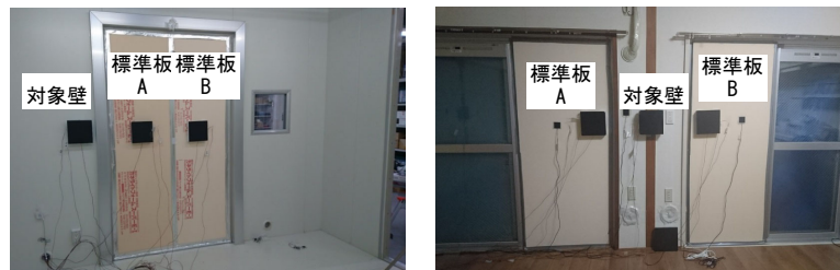
図1 標準板を用いた熱貫流率測定実験
