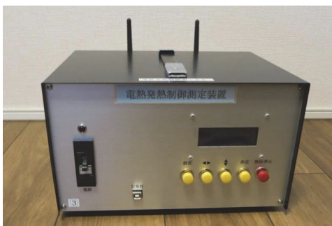
図 1-2 電熱発熱制御装置
