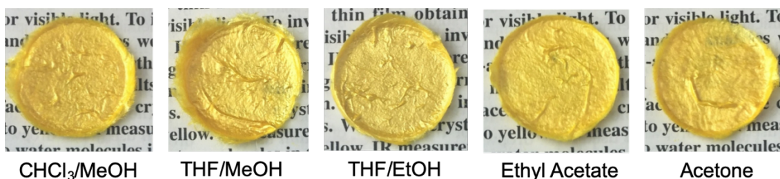
図1. 3 ( n = 4 ) の金色光沢有機結晶積層体写真の下の溶媒は、再結晶溶媒を示す。
