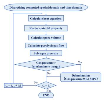
解析方法について述べる.左のフローチャートに従って,アブレータのマルチフィジックス挙動をモデル化した.用また支配方程式は,熱伝導方程式,質量存則,アレイニウス型の化学反応方程式に現れるである.これらの支配方程式に現れるである.これらの支配方程式に現れるを変数をすべて他の実験より決定した.するが表に表した.得られた定数を用いて差分法によりアブレータ内部に層間はが発生するかどうかを予測した.
