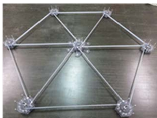
図1 伸展フープ・リブトラス構造
