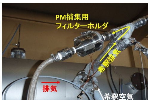
図2 ラボディーゼル機関の排気管に設置した装置でPMを捕集する様子
