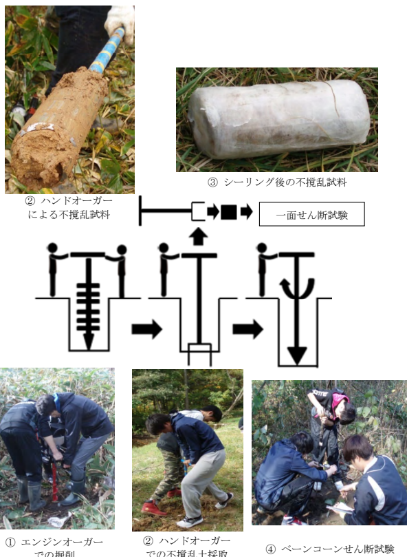
図4 不攪乱試料採取を伴う簡易調査手法
