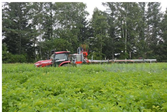
図 4 ロボットトラクタと連携したブーム高さ自動制御付きスプレーヤによる無人防除作業
