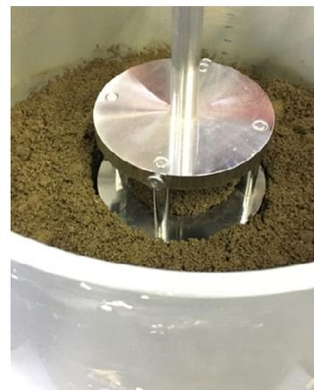
図 4 含水粘性土のリングせん断実験
