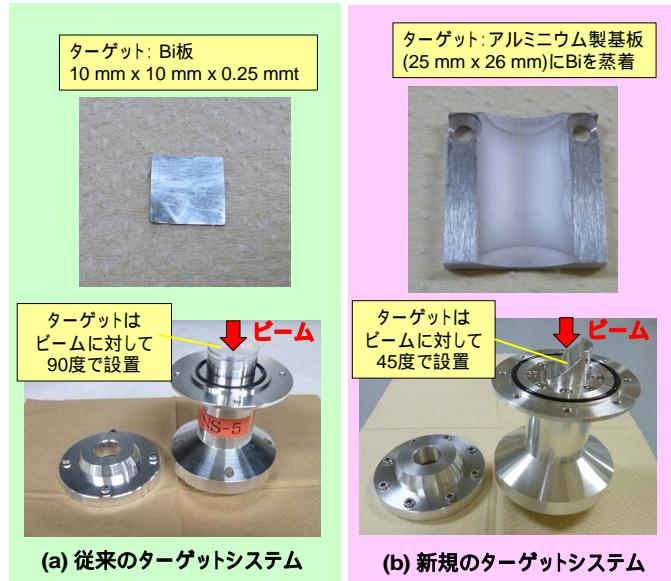
図 1. 従来及び新規のターゲットシステム
