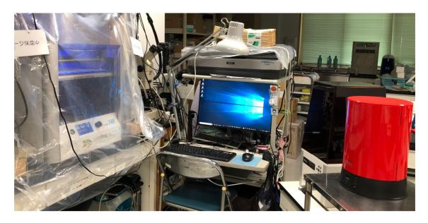
(写真上)使用した3Dプリンターと造形処理用のコンピューター 左 FDM 方式の3Dプリンター(造形空間の保温のため周囲をビニールで囲んでいる) 右 SLA 方式の3Dプリンターと追加重合用の紫外線照射器(造形時は換気扇下へ移動)
